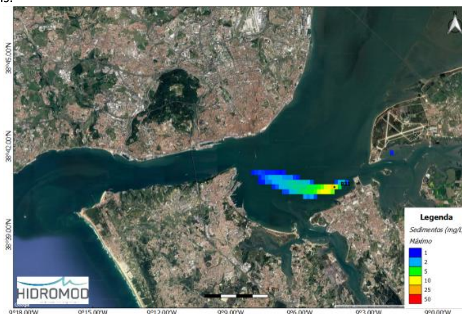
Figura 17 – Pluma de sedimentos (máximo) originada pelas dragagens efetuadas no ponto S31
