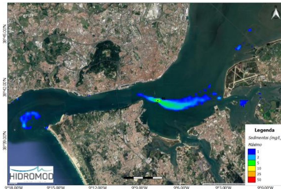
Figura 19 – Pluma de sedimentos (máximo) originada pelas dragagens efetuadas no ponto S1
