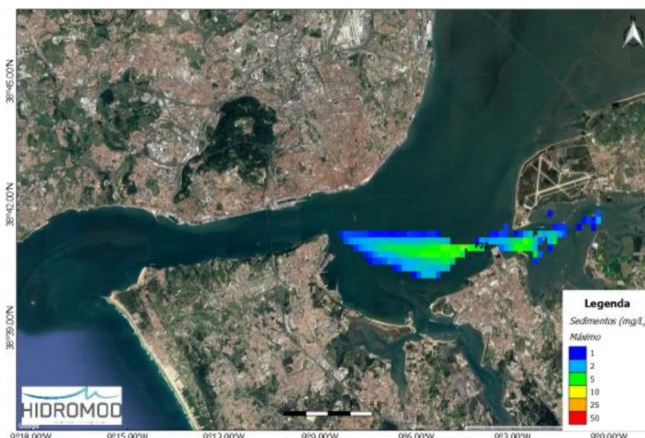
Figura 21 – Pluma de sedimentos (máximo) originada pelas dragagens efetuadas no ponto S22
