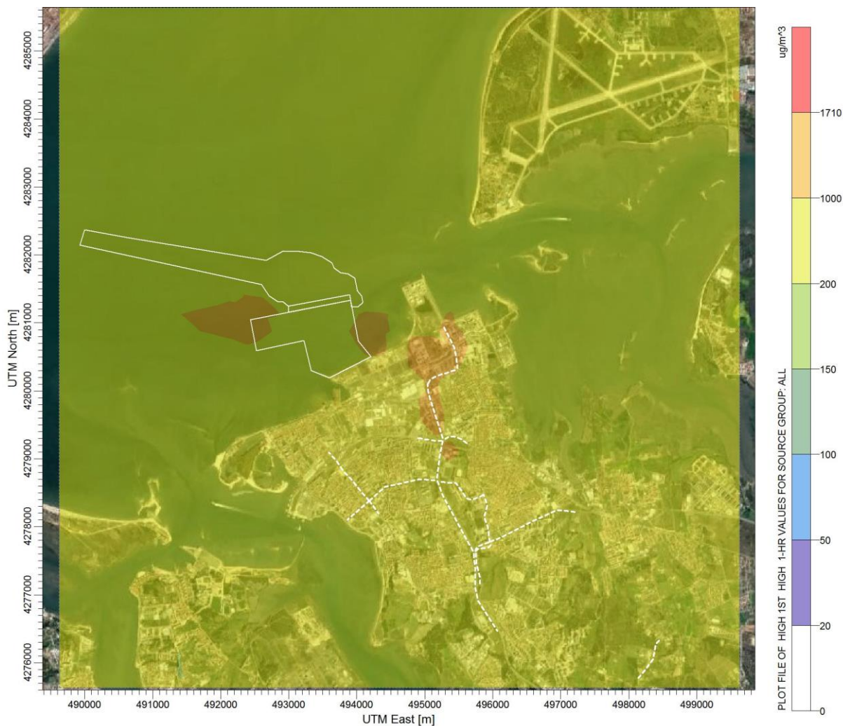
Figura 32 – Campo estimado das concentrações máximas das médias horárias de \text{NO}_2 ( \mu\text{g.m}^{-3} ) verificadas no domínio em análise (Fase 1, Solução 3)
