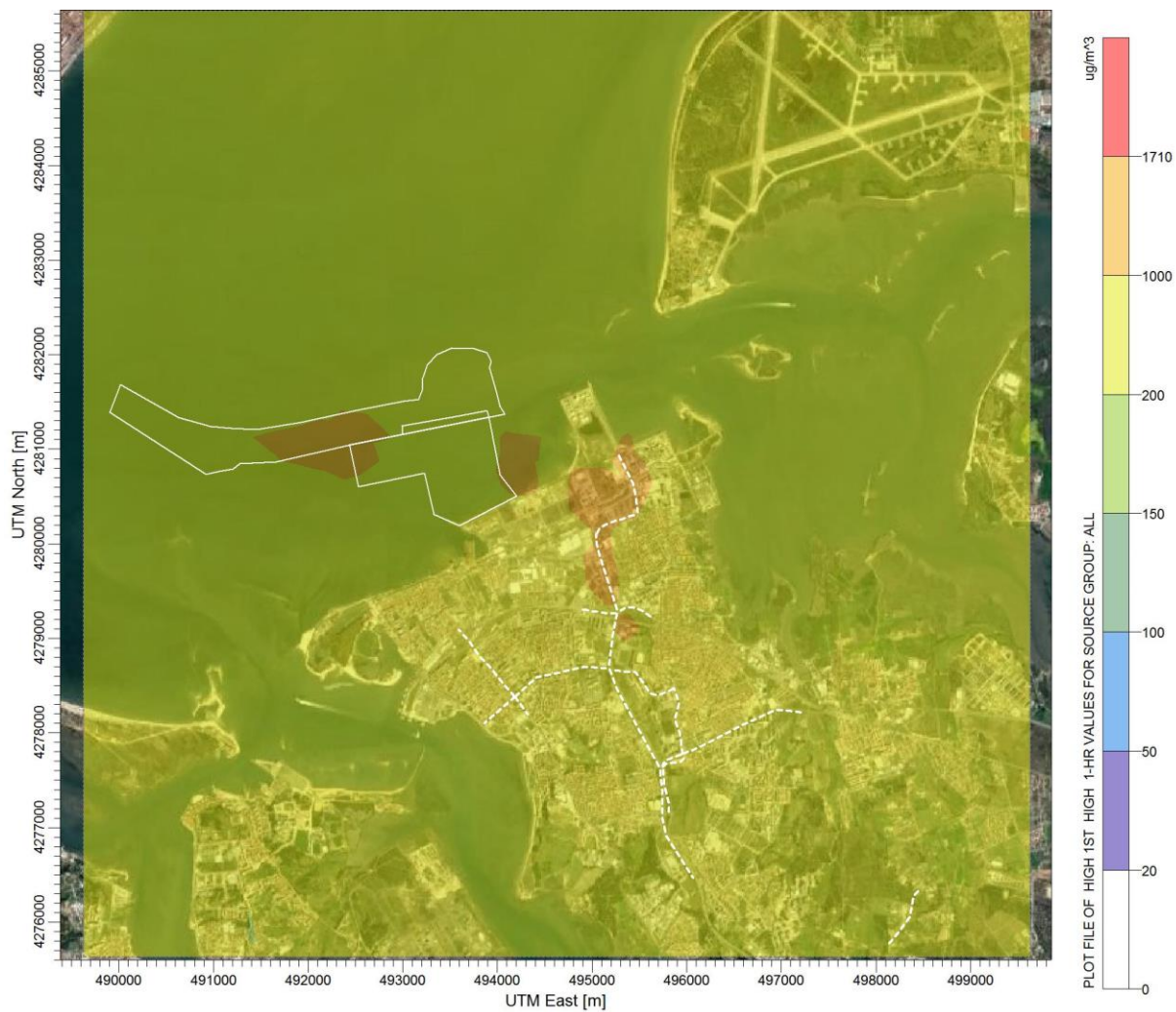
Figura 26 – Campo estimado das concentrações máximas das médias horárias de \text{NO}_2 ( \mu\text{g}\cdot\text{m}^{-3} ) verificadas no domínio em análise (Fase 1, Solução 2)
